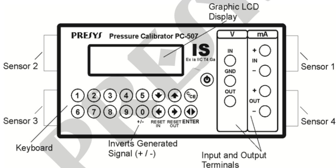
**Fig. 01 – Front Panel**
