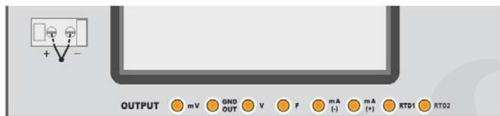
(D) (Front Connection) Use TC compensation wires
